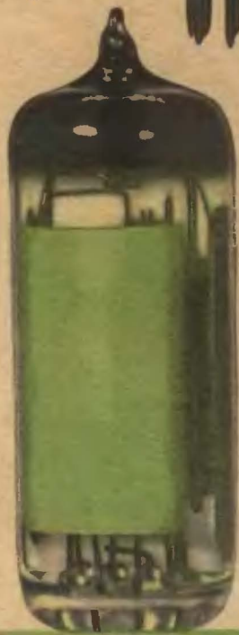
Рис. 1. Внешний вид электронно-лучевого индикатора 6Е2П. (Увеличено в 2 раза).
