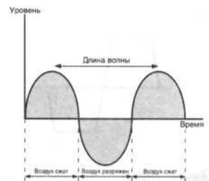
Типичная звуковая волна отражает наше понятие о звуке. Форма волны показывает гармоническое содержание сигнала, количество колебаний в секунду определяет его частоту.
