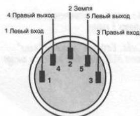
Вид на разъем типа DIN – "папа" со стороны пайки (аналогичен фронтальному виду гнезда "мама")
