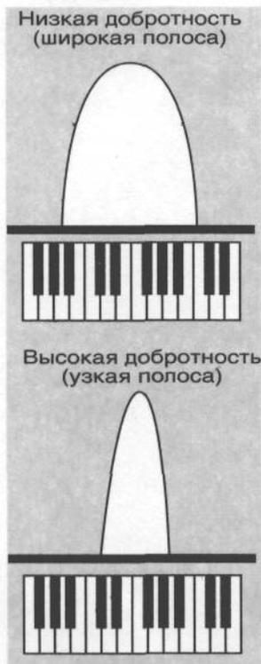
Добротность параметрического эквалайзера  $Q$ . Низкая добротность (широкая полоса) охватывает целую октаву, высокая (узкая полоса) — только несколько нот.
