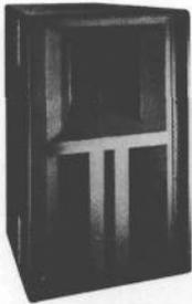
Трехплоскостная акустическая система CE-3T фирмы Renkus-Heinz имеет LF-2x12" (2x350 W RMS), MF-2x6,5" (2x220 W RMS), HF-2x100 W RMS. Чувствительность 107 dB (1 W/1m), SPL 132 dB (cont. prog), полоса частот 50 Hz-18 kHz. Угол раскрытия 60° x 30°, вес 80 кг. Снято из подобной системы подвес.
