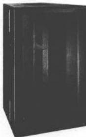
Двухплоскостная акустическая система CE-3TMN фирмы Renkus-Heinz представляет собой mid/high секцию. Чувствительность 113 dB (1 W/1m), SPL 140 dB (cont. prog), полоса частот 250 Hz-18 kHz. Угол раскрытия 60° x 25°. Мощность MF-3x220 W RMS, HF-3x100 W RMS. Вес 74 кг. Представляет компания А4: тел.: (095) 362-7590, 273-4081 E-mail: a4moscow@online.ru
